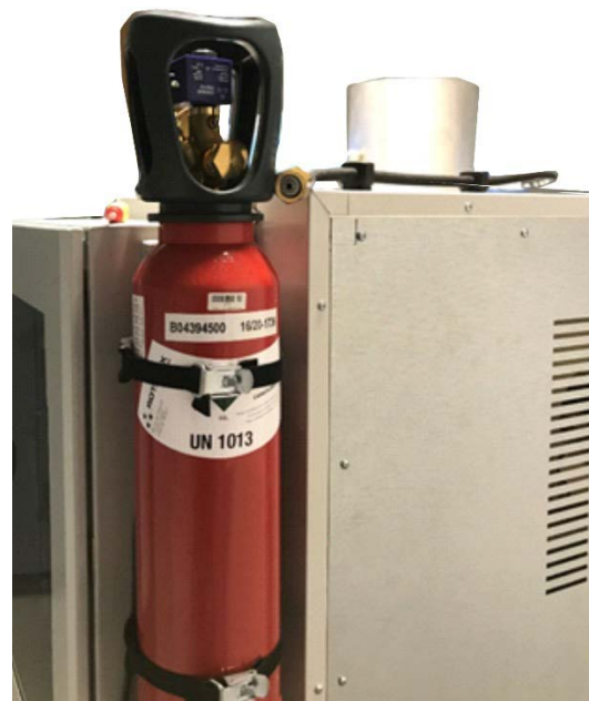
Eingesetzte und fixierte CO 2 Druckgasflasche
