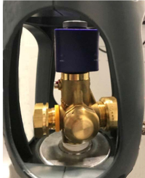
Ventil mit montierter Magnetspule
