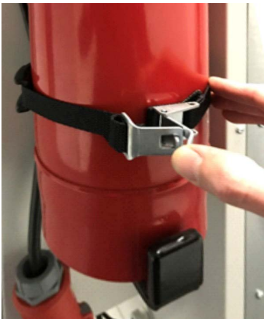
Fixieren der CO 2 Druckgasflasche mit Spanngurt
